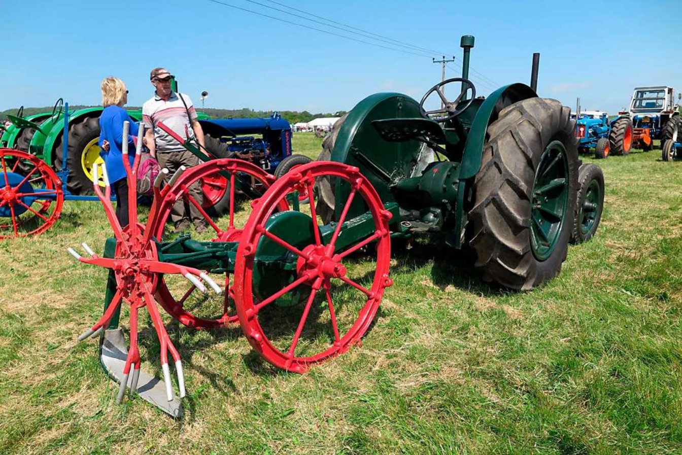
Hansonin perunannostokone traktorin perään kytkettynä. Kuva: Heather Holmesin blogi Scottish agricultural implement makers.
